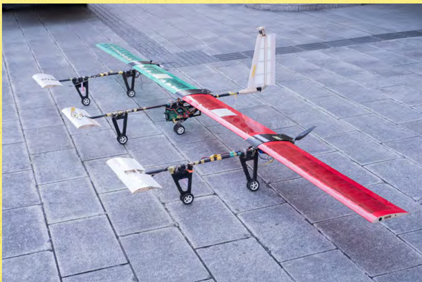
森田が開発するHAPS試験機「Zephyros」。カナードを3枚取り付け付けたユニークな外観だ。 小林 伸
