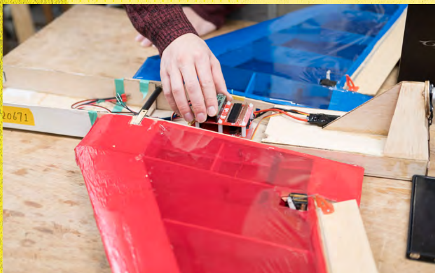
森田が作るHAPSには胴体にマイコンが搭載されている。このマイコンで、姿勢を計算して制御する。 小林 伸
