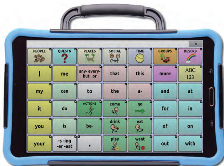
ノバチャット・コミュニケーション・デバイスに標準で搭載されているタッチチャット・ディスプレイ。標準では、どのボタンも同じ大きさで、ボタンの配置、文字の大きさ、大文字・小文字の区別に関して明確な論理性がない。 PRC-Saltillo
